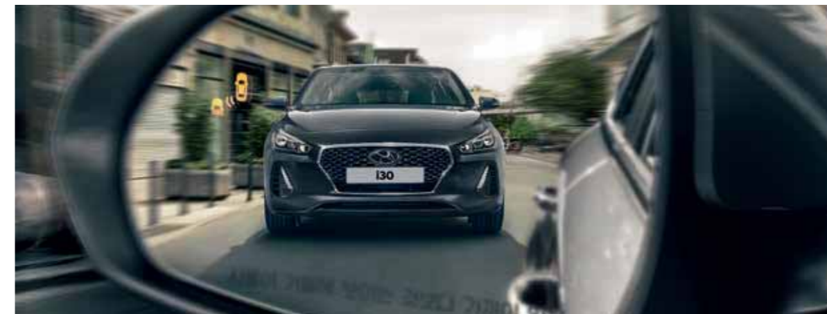
Blind-spot Collision Warning (BCW) waarschuwt voor de aanwezigheid van wagens verborgen in dode hoeken, via visuele en auditieve signalen.
