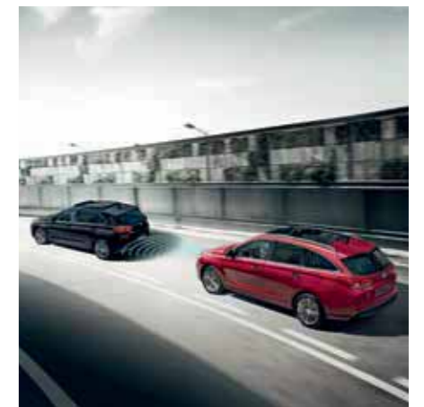
Advanced Smart Cruise Control (ASCC) houdt een veilige afstand tot de voorligger en vertraagt of versnelt automatisch indien nodig.
